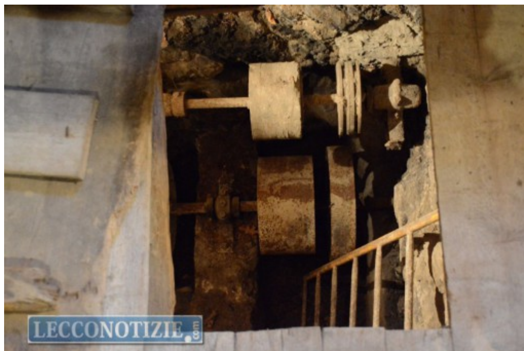
Il sistema meccanico che consente di trasferire il moto alle macine
